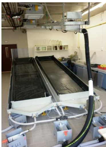
Obr. 2 Simulátor deště Norton nad pokusnými žlaby.
