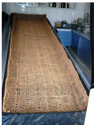
Obr. 4 Kokosová protierozní síť JUTENON ECC 700 umístěna do pokusného žlabu.
