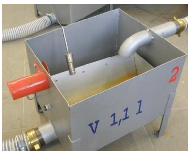
Obr. 3 Mechanický překlápěcí člunkový průtokoměr.
