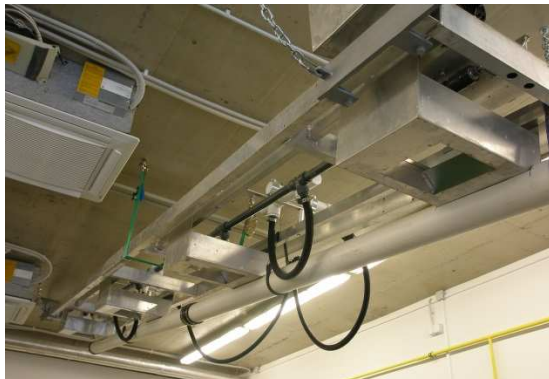
Obr. 1 Konstrukce dešťového simulátoru Norton v laboratoři Fakulty životního prostředí, České zemědělské univerzity v Praze.
